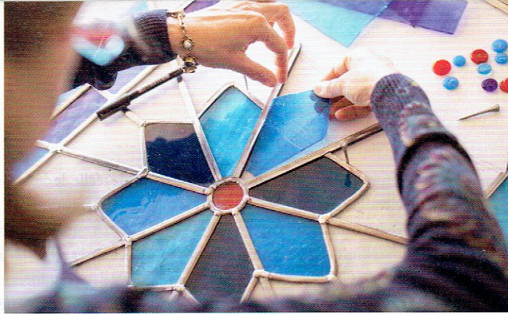
Chaque pièce de verre est disposée entre les tiges de plomb puis maintenue à l'aide de clous en attendant le placement de la pièce suivante.
